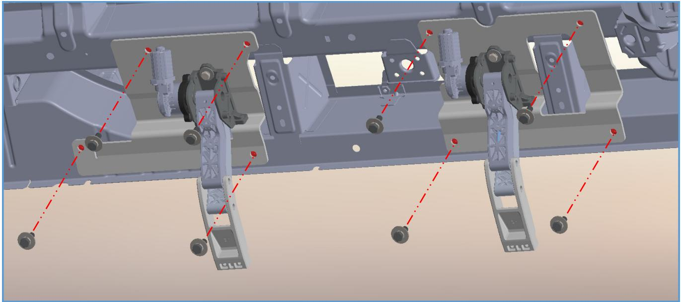
Anschließend die Gelenkhalterungen montieren.
