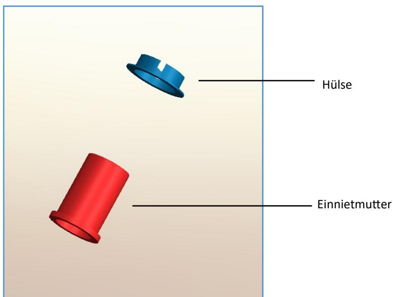
Schieben Sie die Hülsen über die Einnietmutter und befestigen Sie diese an den lokalisierten Stellen.
