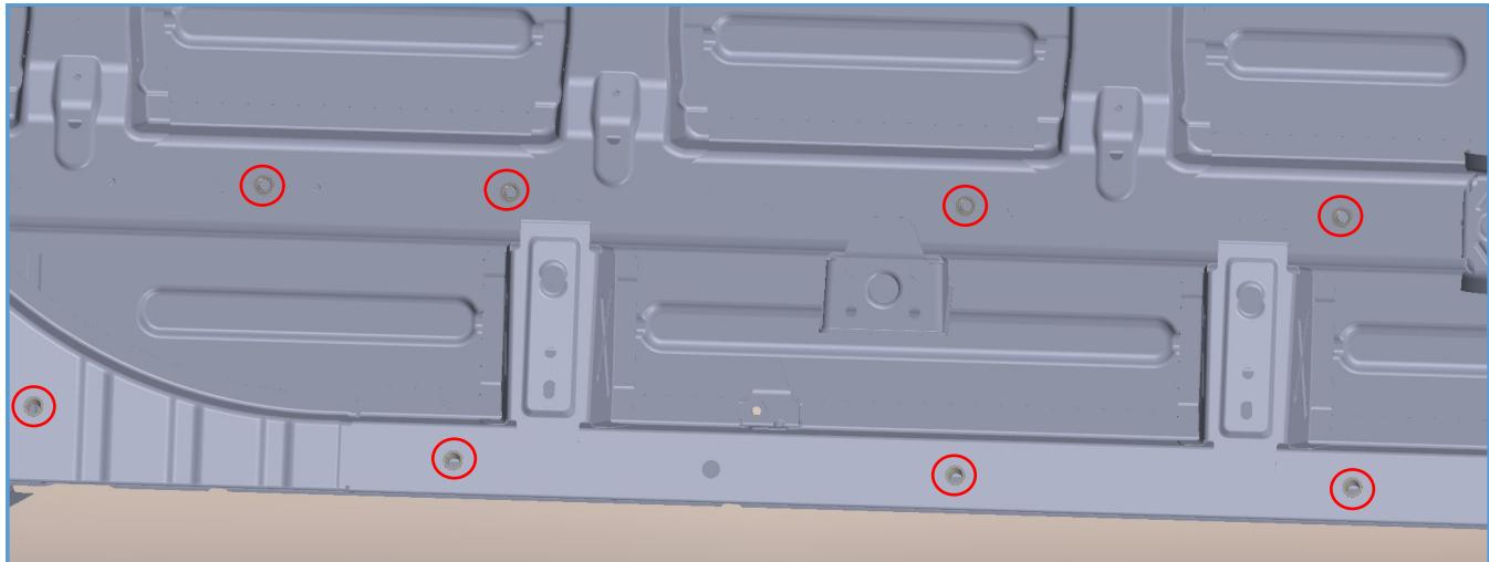
Einbringen der M12er Einnietmutter mit Hülse
