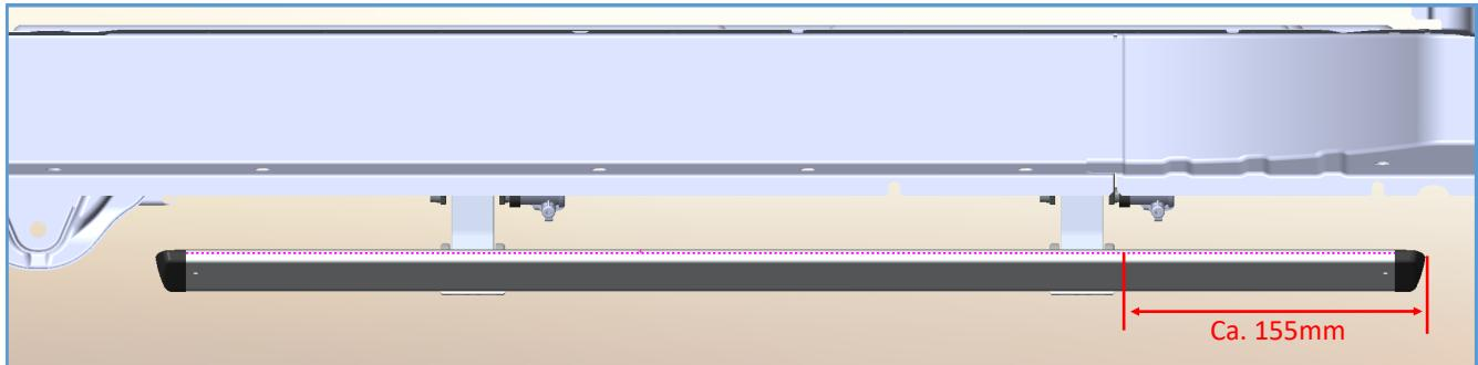
Verschrauben sie das Trittbrett mit den M8 ISK-Zylinderkopfschrauben mit je zwei Sprengringen.
