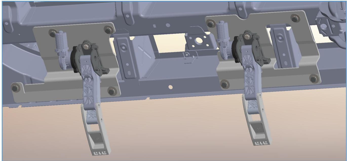
Ziehen Sie die Verschraubungen fest und Prüfen Sie diese auf selbständiges Lösen (Federring vorhanden, ggf. Schraubensicherung Loctite verwenden).
