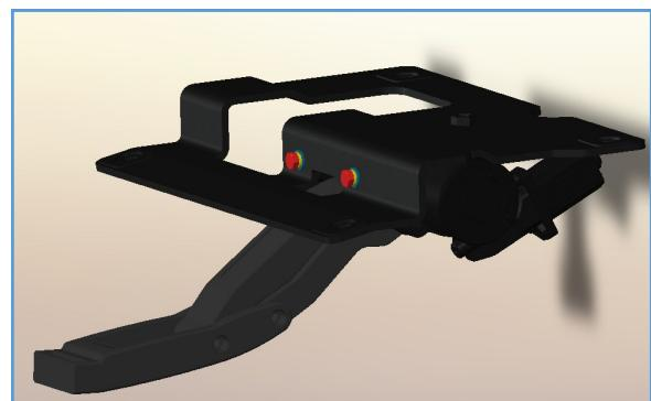
Auf der Halter Unterseite wird das Gelenk noch mit einer M10er **Schraube**, einem **Federring** und einer **U-Scheibe** befestigt.
